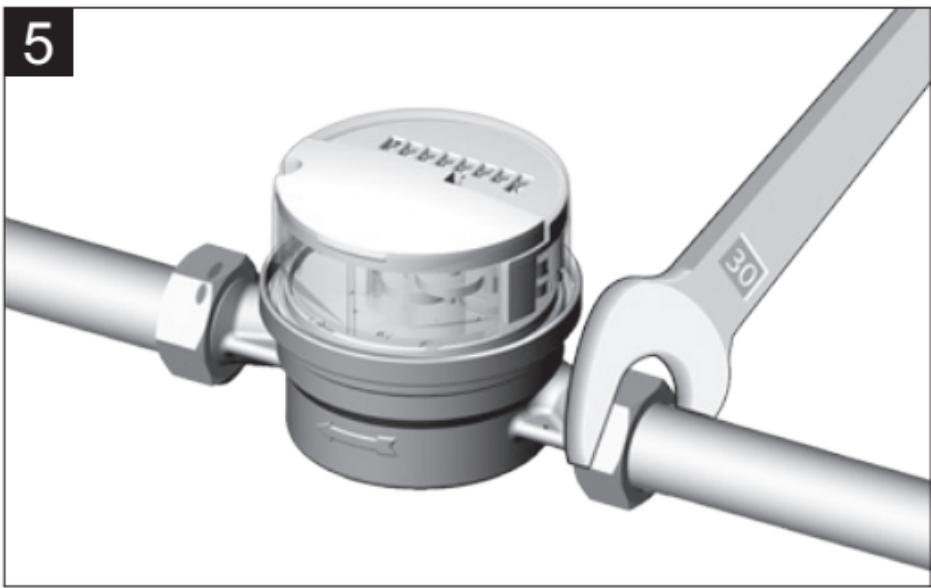
Neuen Zähler mit neuen Dichtungen installieren
