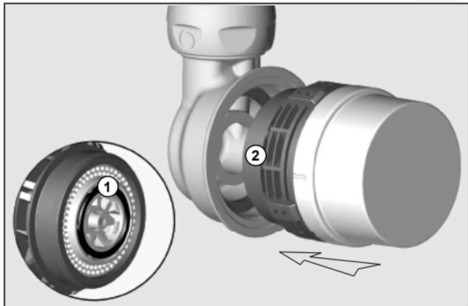
de ① Prüfen, ob O-Ring an der Unterseite des Zählers richtig in der Nut sitzt und ggf. korrigieren.
