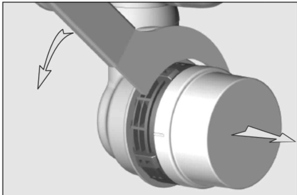
de Netz-Wasserleitung leeren. (Zapfstellen öffnen) Messkapsel mit dem Montageschlüssel lösen und Messkapsel und Dichtungen entfernen.
