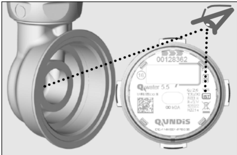
de Überprüfen, ob die Messkapsel für den Einbau in das Anschluss-Gehäuse geeignet ist. Messkapsel und Anschluss-Gehäuse müssen mit „IST“ gekennzeichnet sein.
