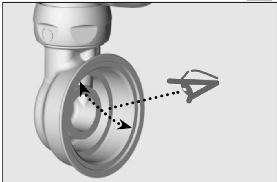
de Dichtflächen und Gewinde im Anschluss-Gehäuse auf Beschädigung und Verunreinigung prüfen und ggf. säubern.
