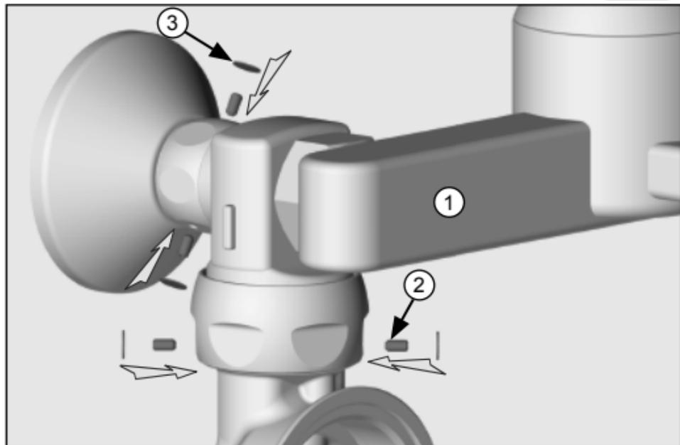
de Badewannenarmatur ① mit neuen Dichtungen montieren (Dichtungen nicht im Lieferumfang), 4 x Gewindestifte zur Fixierung einschrauben ②, 4 x Werkszeichen aufkleben ③.
