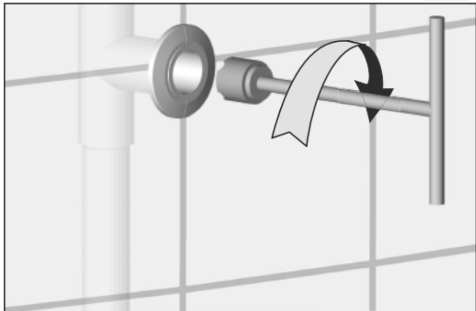
de Ventilsitz mit Fräser reinigen, Fremdkörper entfernen.
