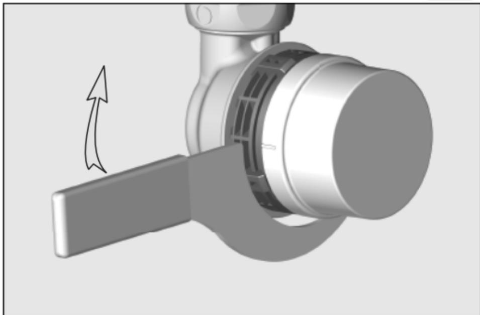
de Mit dem Montageschlüssel festziehen (ca. 35 - 40 Nm).
