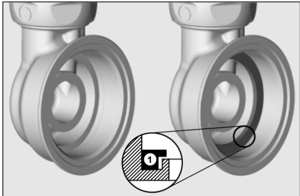
de ① Profildichtung (Bestandteil der Messkapsel) mit der Planseite nach oben in das Anschluss-Gehäuse einlegen.
