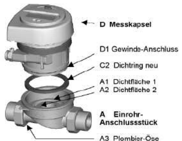
Abb. 2 Einbau PolluCom C/S RI Messkapsel
